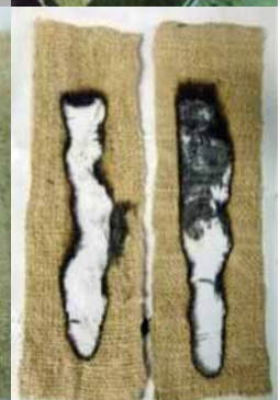
การทดสอบผ้าเฮมพ์กันน้ำ และทนวงไฟ สำหรับการนำไปใช้ผลิตผลิตภัณฑ์เคหะสิ่งทอ (Home Textiles)
