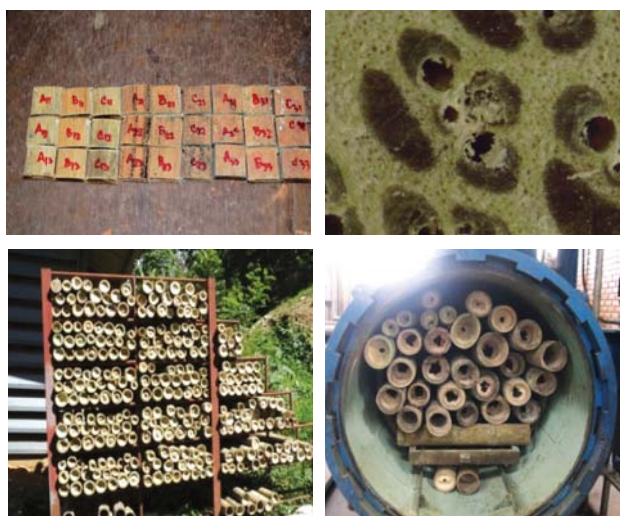
การพัฒนาวิธีการใช้สารเคลือบเนื้อไม้ CCA และ CCB เพื่อยืดอายุการใช้งานไม้ไผ่
