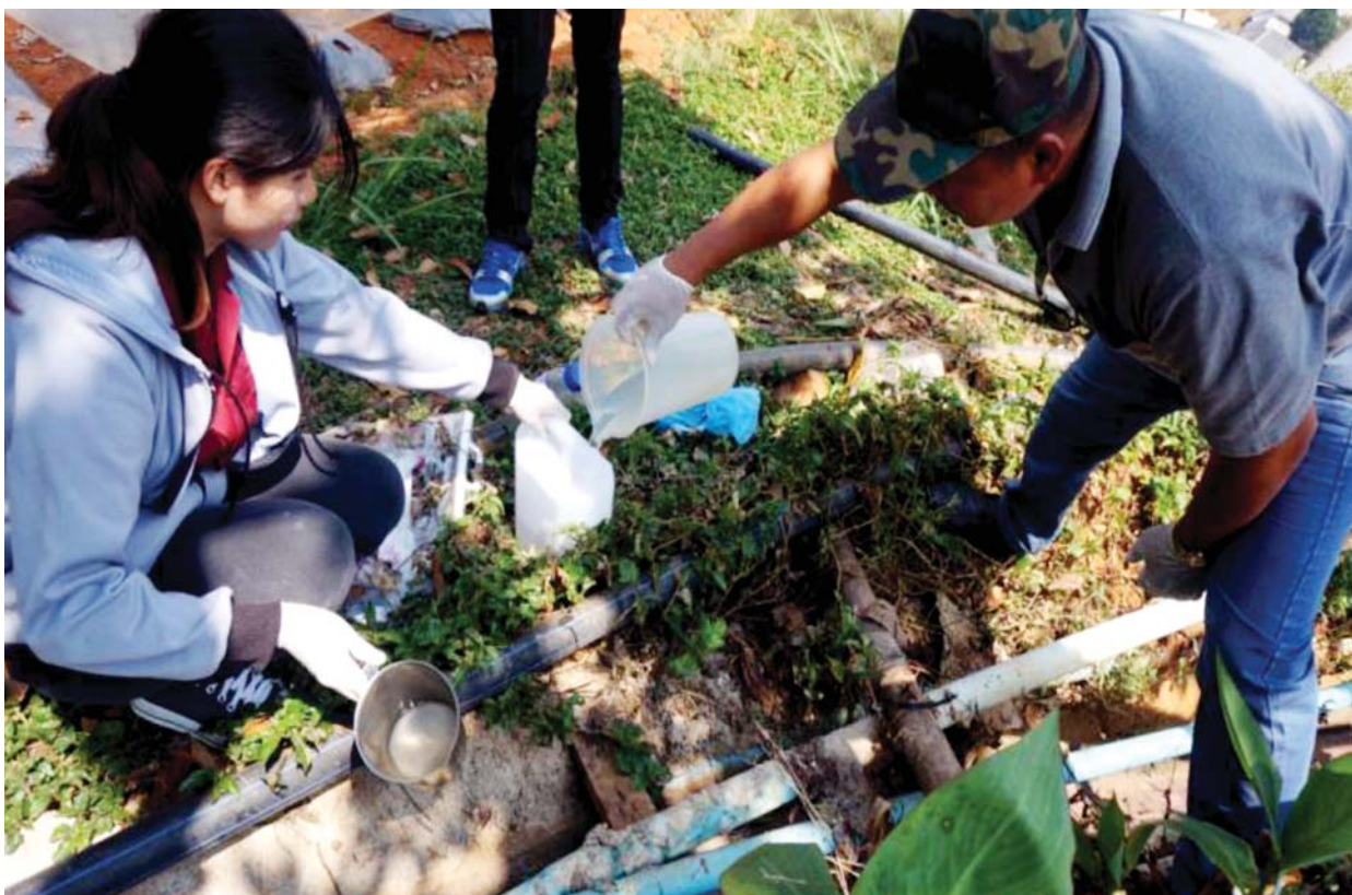
ขั้นตอนการเก็บตัวอย่างน้ำเสียจากครัวเรือน/ชุมชน
