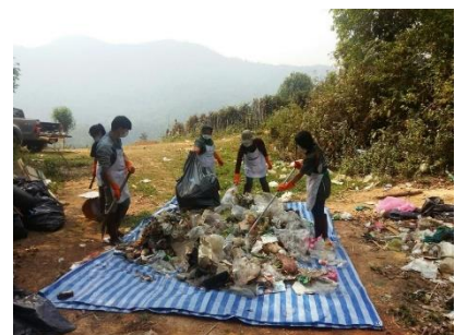
การวิเคราะห์ห้องค์ประกอบขยะ ด้วยวิธี Quartering
