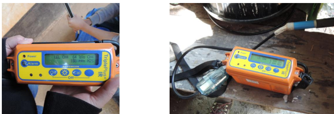
ภาพที่ 54 เครื่องวัดปริมาณก๊าซ (Gas Analyzer) และวิธีการวัดไบโอแก๊ส
