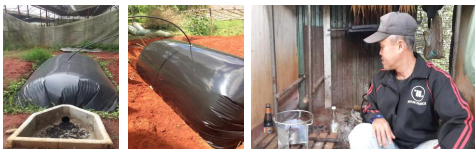
ภาพที่ 53 บ่อไบโอแก๊สและการจุดติดไฟในพื้นที่ศูนย์พัฒนาโครงการหลวงป่าเมี่ยง
